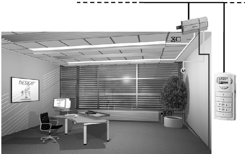
Интегрированная работа управления климатом, освещения и жалюзи с DESIGO RXC
